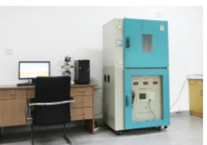
模拟EV车高频电晕老化试验仪器
